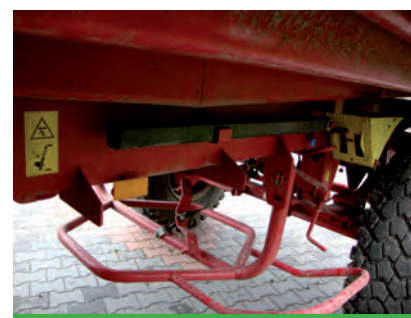
Mechaniczna blokada skrzyni przyczepy przy pracach pod uniesioną skrzynią.
