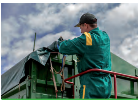
Zabezpieczenie plandeką skrzyni ładunkowej przy przewozie ładunków sypkich.
