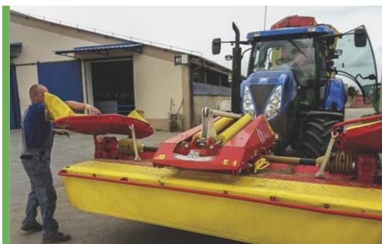
Przygotowanie do przejazdu transportowego.
