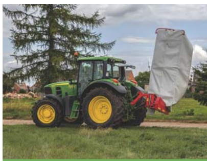
Przejazd z kosiarką w położeniu transportowym.
