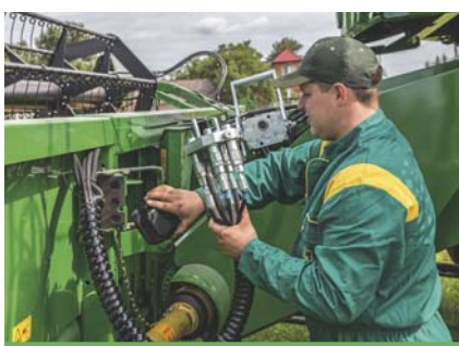
Poza pomostem (kabiną) kombajnu czynności obsługowe należy wykonywać przy wyłączonym silniku.
