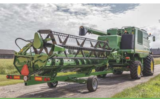
Przewożenie przyrządu żniwnego z umieszczoną z tyłu trójkątną tablicą, wyróżniającą pojazd wolno poruszający się.
