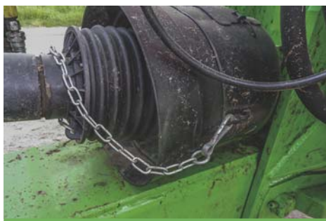
Łańcuszek zabezpieczający osłonę przed obracaniem przez przypięcie do nieruchomej części rozrzutnika.
