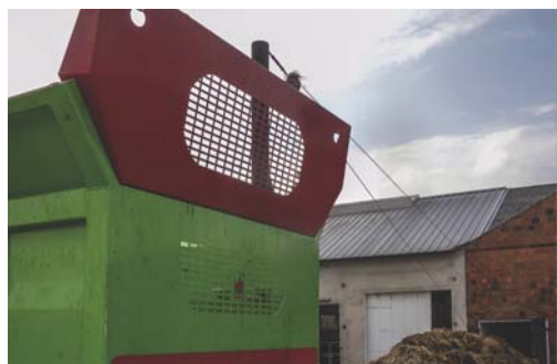
Siatka ochronna na przedniej burcie chroni przed twardymi przedmiotami podczas roztrząsania obornika.
