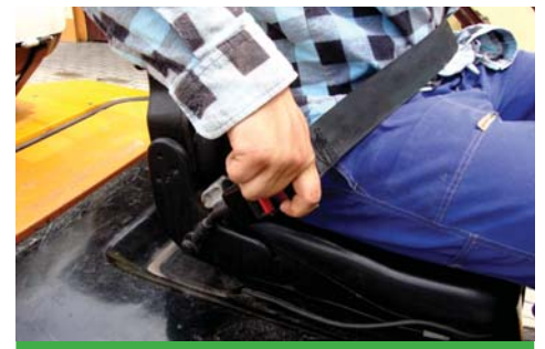
Zapięcie pasów bezpieczeństwa przed uruchomieniem silnika wózka.
