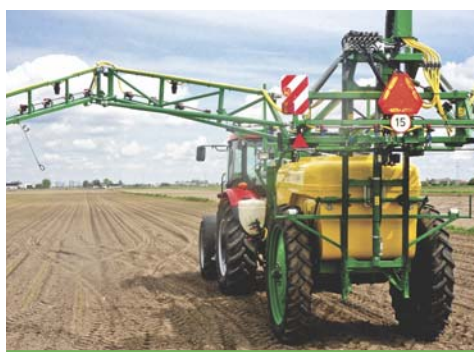
Automatyczne rozkładanie belki polowej i jej poziomowanie.
