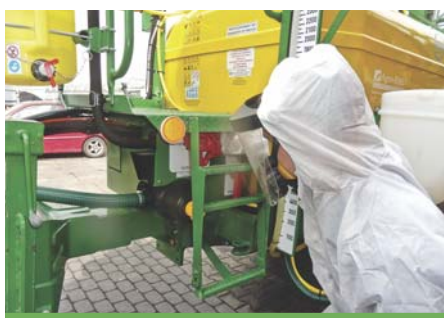
Uruchamianie rozładniwa środka ochrony roślin w celu przygotowania cieczy roboczej.
