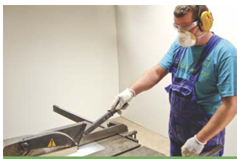
Stosowanie maski przeciwpyłowej przy pracach w zapyleniu i cięciu drewna twardego.
