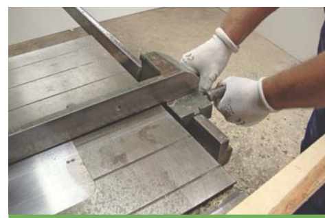
Ustawianie prowadnicy – w rękawicach ochronnych – brak ryzyka pochwycenia.
