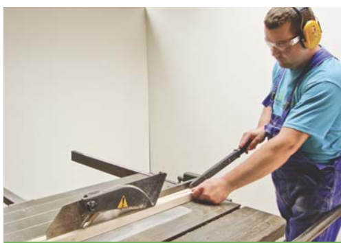
Używanie popychacza w końcowej fazie cięcia wzdłużnego.
