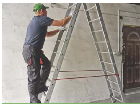
Zabezpieczenie drabiny rozstawnej mechanizmem blokującym.
