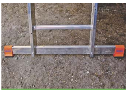
Zabezpieczenie dołu drabiny przed przewróceniem przez używanie stabilizatora.
